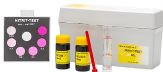
абор для метода сравнения цветности при концентрации 0 – 1 мг/л NO<sub>2</sub>. Фиксированные значения 0,05 – 0,1 – 0,2 – 0,3 – 0,5 – 1 мг/л. Разбавлением пробы воды 1:10 диапазон измерения может быть расширен до 10-кратного увеличения концентрации. В комплекте с реагентом.
