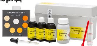
Набор для метода сравнения цветности при концентрации 0 – 5 мг/л Cl<sup>-</sup>. Фиксированные значения: 0,1 – 0,25 – 0,5 – 1 – 2,5 – 5 мг/л, в комплекте 2.
