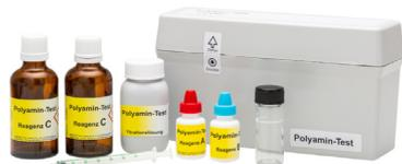
Тестовый набор предназначен для определения содержания полиаминов в водном контуре котла. Адаптация титрирующего раствора в зависимости от продукта. Комплект включает необходимые реагенты.
