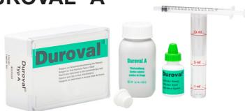
Набор для определения жесткости воды для всей жесткости методом комплексометрическим титрования титрующей жидкостью в градусах жесткости и калиброванной дозирующей пипеткой.
