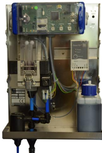
**Testomat® LAB TH** определяет автоматически по методам титрования жесткость воды. Данный прибор предназначен для контроля качества воды при водоподготовке, при работе оборудования для питьевой воды, для промышленных котлов, а также контроля технологической воды.
