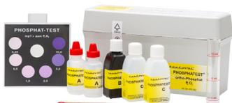
Набор для метода сравнения цветности при концентрации 0 – 10 мг/л P<sub>2</sub>O<sub>5</sub>. Фиксированные значения: 0,25 – 0,5 – 1 – 2,5 – 5 – 10 мг/л. Разбавлением пробы воды 1:10 диапазон измерения может быть расширен до 10-кратного увеличения концентрации. В комплекте 3 реагента.
