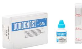
Жидкий специальный индикатор, бутылка с каплями для контроля остаточной жесткости в умягченной воде, определяет по границам 0,1 и 0,05 °dH (1,79 и 0,89 ppm). В комплекте с мерной трубкой и пробкой.
