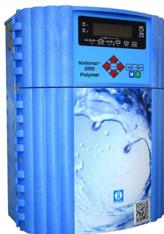
Процессный фотометр **Testomat 2000® Polymer** измерительный прибор онлайн анализа для контроля содержания полиакрилатов в диапазоне от 0 до 50 мг/л (ppm) (для установленного специфического фактора продукта 1,00) с применением фотометрического принципа анализа.
