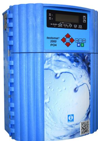
Процессный фотометр **Testomat 2000® PO<sub>4</sub>** является измерительным прибором онлайн анализа для контроля содержания орто фосфата в диапазоне от 0 до 10,0 мг/л (ppm) с применением принципа фотометрического анализа.
