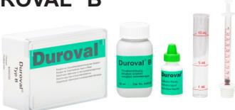
Набор для определения жесткости в очень умягченной пробе воды титрованием жидким титровальным средством и пипеткой калиброванной в единицах градуса жесткости. Комплект с измерительными трубками, жидким индикатором и калиброванной пипеткой 0 - 2 °dH.
