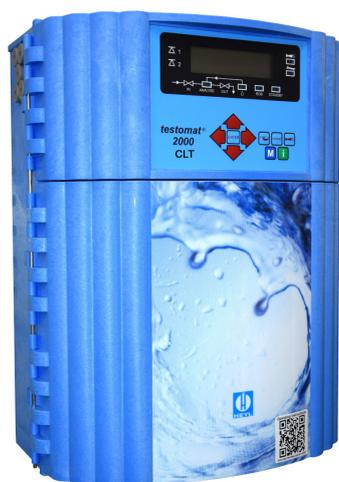
Процессный фотометр **Testomat 2000® CLT** является измерительным прибором онлайн анализа для контроля содержания общего хлора (CLT) в диапазоне 0– 2,5 мг/л (ppm); переключается на свободный хлор в таком же диапазоне измерений.
