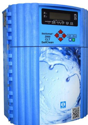
Процессный фотометр **Testomat 2000® CLT Self Clean** с дополнительной функцией очистки измерительной камеры является измерительным прибором онлайн анализа для контроля содержания общего хлора (CLT) в диапазоне от 0– 2,5 мг/л (ppm); переключается на свободный хлор в таком же диапазоне измерения.
