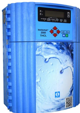
Процессный фотометр **Testomat 2000 THCl®** определяет содержание общего хлора DPD методом в диапазоне от 0 до 2,5 мг/л (ppm) и жесткость в диапазоне от 0,25 до 2,5° dH при помощи титрования.
