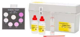
Набор для метода сравнения цветности при концентрации 0 – 1 мг/л Fe. Фиксированные значения: 0,05 – 0,1 – 0,25 – 0,5 – 0,75 – 1 мг/л. Разбавлением пробы воды 1:10 диапазон измерения может быть расширен до 10-кратного увеличения концентрации. В комплекте 2 реагента.
