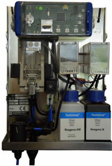
**Testomat® LAB Monochloramin (NH<sub>2</sub>CL)** измерительный прибор онлайн анализа, определяющий фотометрическим методом содержание монохлорамина в технологической воде. Данный прибор предусмотрен для постоянного мониторинга качества технологической воды, например в контуре охлаждения. Другие области применения: в проектах водоподготовки и в оборудовании для питьевой воды. Также прибор предназначен для мониторинга распада после интенсивного хлорирования в градирнях.
