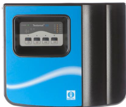
**Testomat® 808** является компактным прибором анализа онлайн измерений жесткости воды по принципу мониторинга предельных значений с изменением цвета в диапазоне 0,02 – 5 ° dH (0,4 - 89 ppm).
