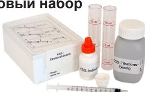
Измерительный набор для простого мониторинга смазочно-охлаждающих веществ (KSS) с использованием метода титрования.
