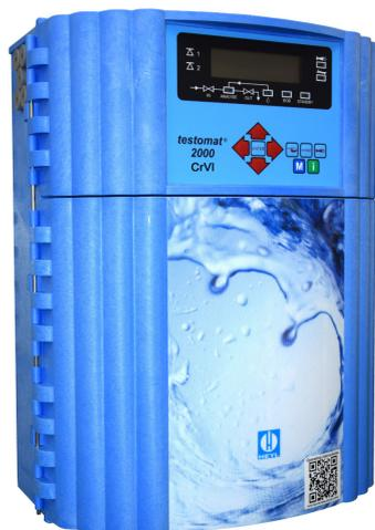
Процессный фотометр **Testomat 2000® CrVI** является измерительным прибором онлайн анализа для контроля содержания хромата ( $\text{CrO}_4^{2-}$ ) или хрома VI ( $\text{CrVI}$ ) в воде. Данный прибор работает по принципу фотометрического анализа согласно DIN 38405. Для реализации различных требований к измерению предусмотрены два варианта прибора.
