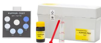
Набор для метода сравнения цветности при концентрации 0 – 2 мг/л Cu. Фиксированное значение: 0,1 – 0,25 – 0,5 – 1,0 – 1,5 – 2 мг/л, в комплекте с реагентом.
