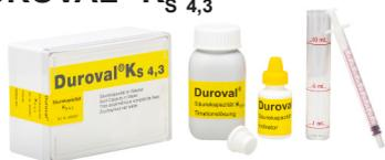
Титрирующий набор для определения кислотной емкости до pH 4,3. Комплект с измерительными трубками, дозирующей пипеткой (калиброванной), со специальным штекерным соединением, 8 мл индикатора и 50 мл титрирующего раствора.
