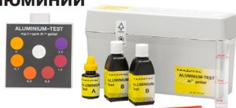
Набор для метода сравнения цветности при концентрации 0 - 15 мг/л Al. Фиксированные значения: 0 - 0,1 - 0,2 - 0,5 - 1 - 1,5 мг/л. Возможность разбавления пробы воды 1:10 диапазона измерения
