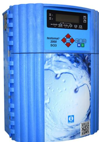
Процессный фотометр **Testomat 2000® SO3** является измерительным прибором онлайн анализа для контроля содержания сульфита SO<sub>3</sub> в диапазоне от 0 до 50 мг/л с применением принципа фотометрического анализа.
